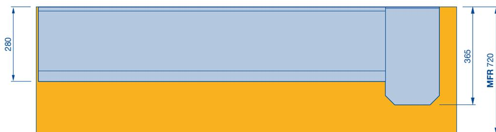
**BPA** Spazio necessario per il montaggio/ smontaggio della motorizzazione
