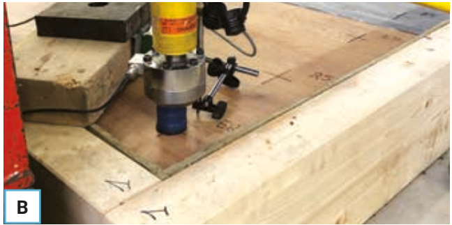
Test di carico su pavimentazione in parquet non incollato.
