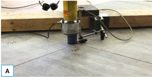
Test di carico su pavimentazione in gres porcellanato.
