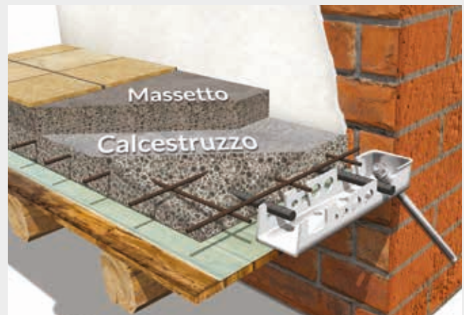
Perimetro Forte è l'innovativo sistema di cerchiatura perimetrale con funzione antisismica composto da Connettore Perimetrale e Ancorante Chimico.
