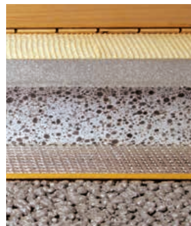
Soluzioni di pavimento galleggiante con i sottofondi leggeri e isolanti Leca con l'interposizione di un materassino acustico anticalpestio.
