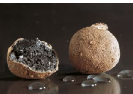
Argilla espansa LecaPiù, principale componente dei premiscelati Laterlite.
